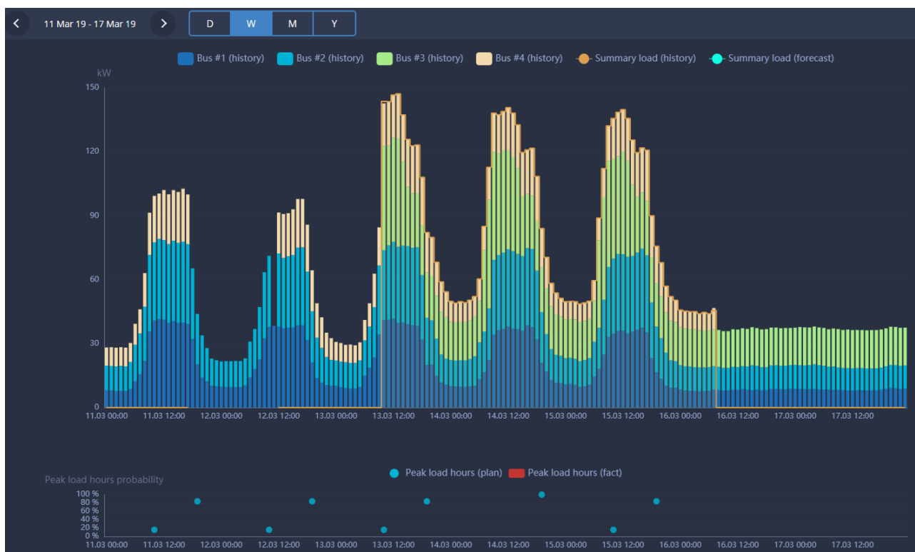
Рисунок 35. Пример вывода данных технического учета электроэнергии
