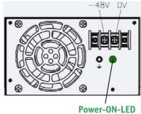
Fig. 22: Detail: -48VDC-Netzteil (400W)
