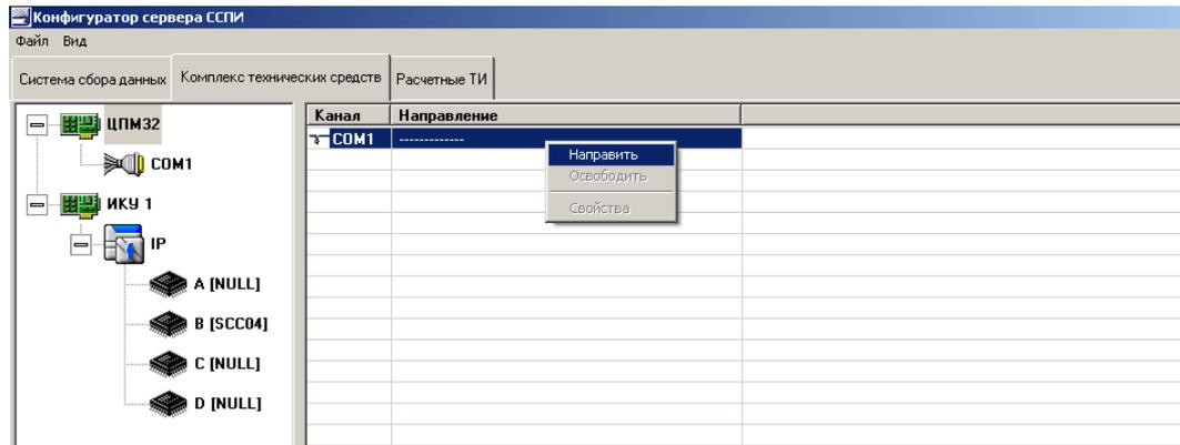
Рисунок 48. Привязка физического канала к каналу направления
