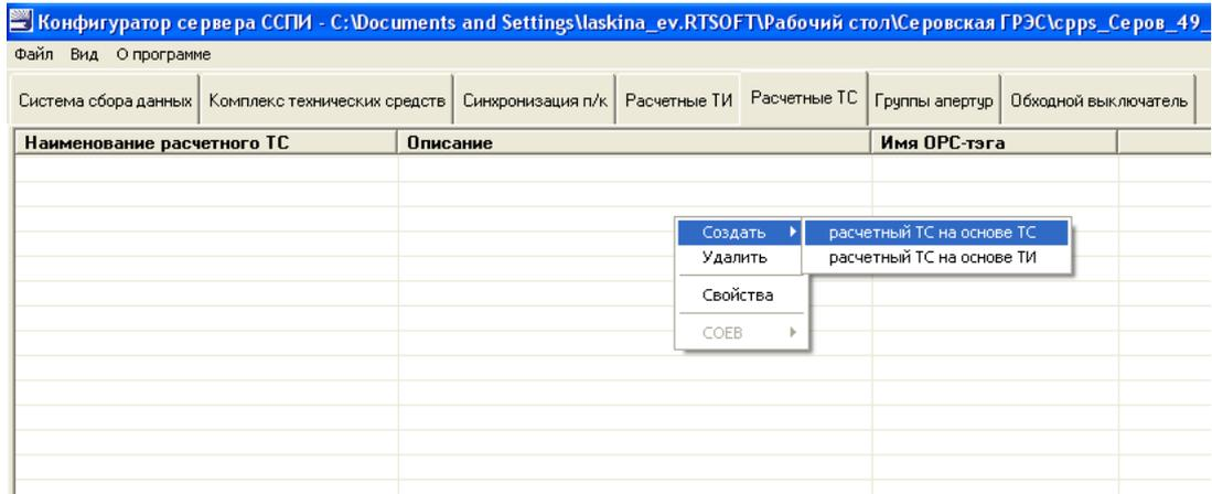
Рисунок 57. Закладка «Расчетные ТС» и контекстное меню для списка расчетных ТС
