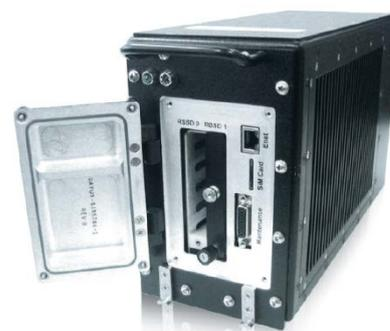
// Сервер со съемным SSD-модулем, установленным в слоте RSSD 1
