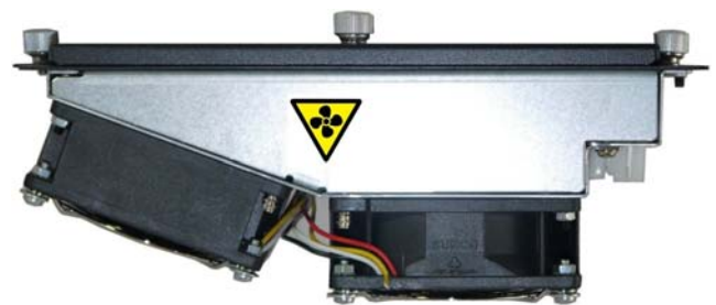
Fig. 35: Side view of the fan slide-in module
